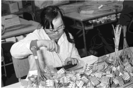
Abb. 14: Geschützte Arbeit in der Rehabilitationswerkstatt Berlin-Köpenick. Tätigkeit: Winkelmontage für die Herstellung von Teilen für einen Kabelbaum
