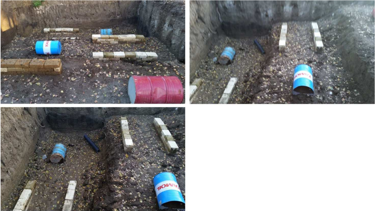
Figura 2. Posizionamento dei fusti metallici, muretti di tufo e tubo in PVC all'interno dello scavo.
