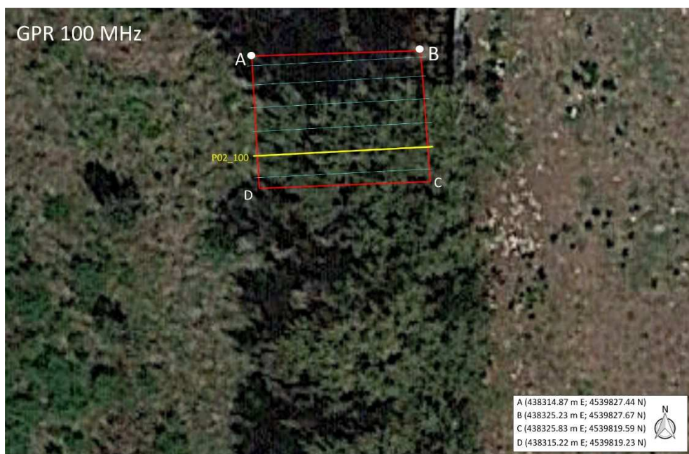
Figura 4. Grid del GPR survey con antenna a 100 MHz.
