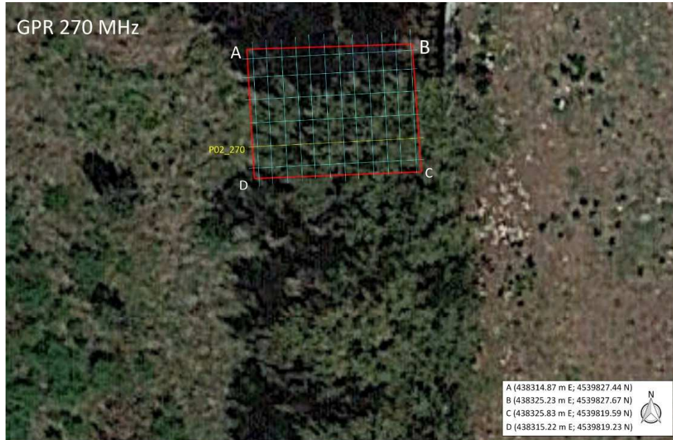
Figura 5. Grid del GPR survey con antenna a 270 MHz.
