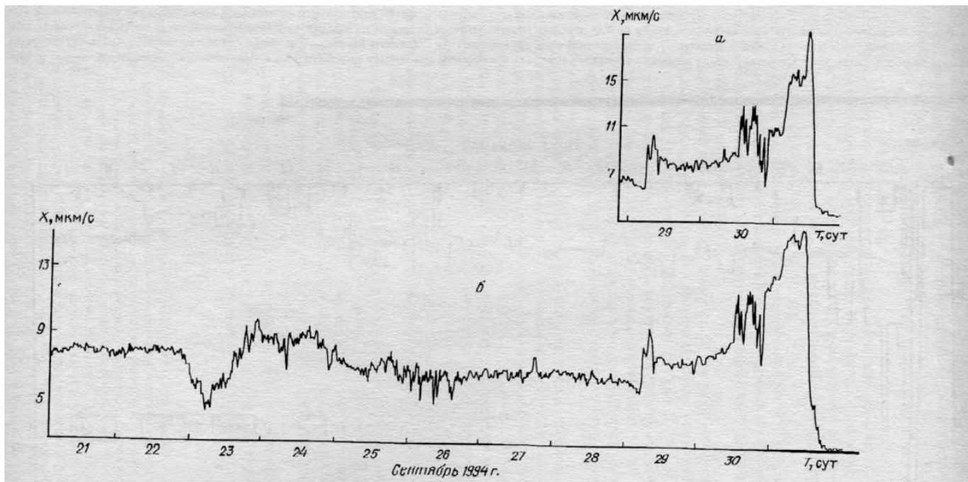
Рис. 3. Среднеквадратическое значение скорости смещения грунта (Z-канал) по наблюдениям на сейсмических станциях ZLN (а) и PDK (б). Осреднение с постоянной времени 170 с;  $T$ -местное время,  $X$  - среднеквадратическое значение скорости смещения грунта
