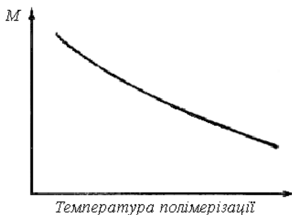
Рис. 11.2. Зміна відносної молекулярної маси полімеру M при різній температурі полімеризації
