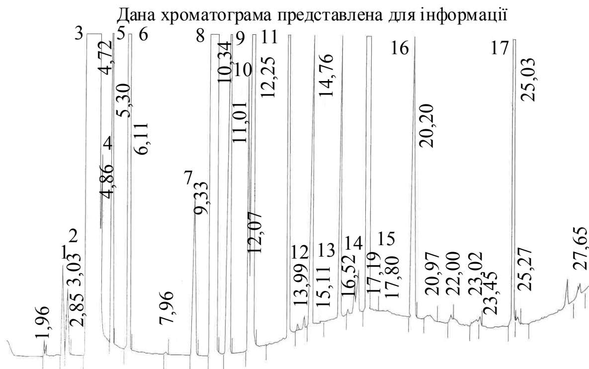
Рисунок 3.10 – Леткі домішки: типова хроматограма суміші етанолу і шістнадцяти домішок
