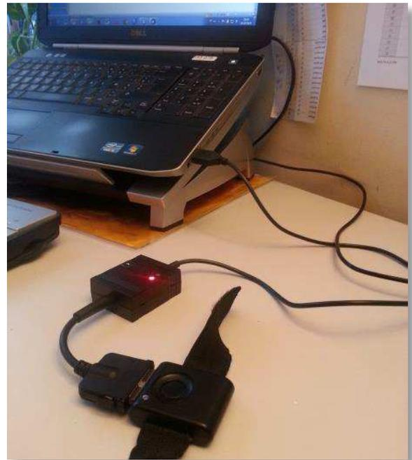
Ensuite, un port USB permet de transférer les données sur l'ordinateur et de calculer différents scores d'agitation (moyenne et déviation standard, pic minimum et maximum d'agitation, pourcentage de temps passé dans la zone haute, médium ou basse d'agitation).
