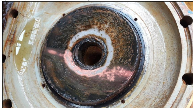
Figura 20 Efectos de la acidez en los componentes de la bomba.
