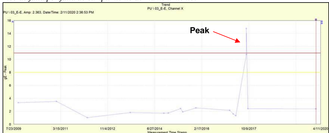
Figura 16 Pico de falla por falta de cumplimiento de mantenimiento.
