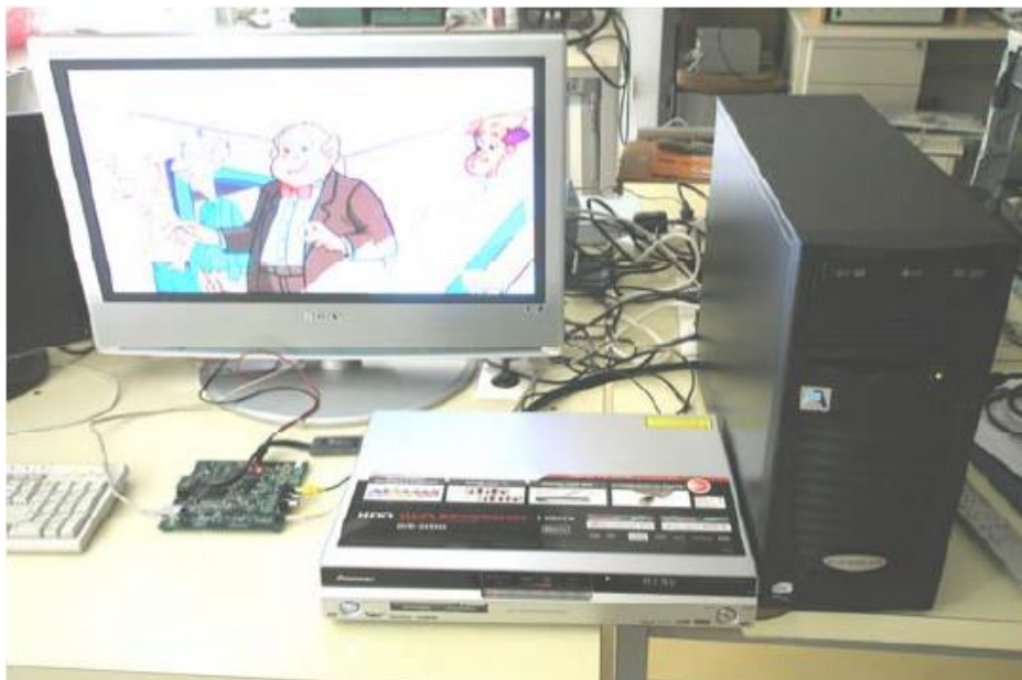
Figura 8. Ejemplo de experiencia en laboratorio usando un DVD formato MPEG4-H.264 y una Tarjeta Electrónica DSP EVM DM Series. Fuente. Foto ejemplo de experiencia propia
