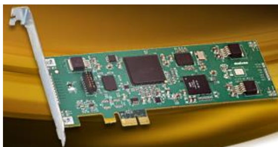
Figura 24. Tarjeta de Aceleración de Codificación de video H.264 MAX. Fuente. Foto ejemplo para experiencia propia
