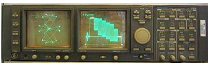
Figura 5. WFM (waveform monitor) con vectoscopio mostrando barras estándar de color EBU (European Broadcasting Union). Fuente. Recuperado de http://profesores.elo.utfsm.cl/~agv/elo330/2s05/projects/Perez/Algoritmos.htm
