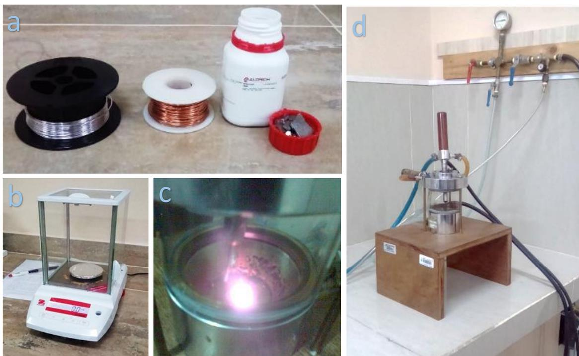
**Figura 3.2.** a) Elementos precursores, b) balanza analítica, c) muestra de cuasicristal recién sintetizada y d) horno de arco.
