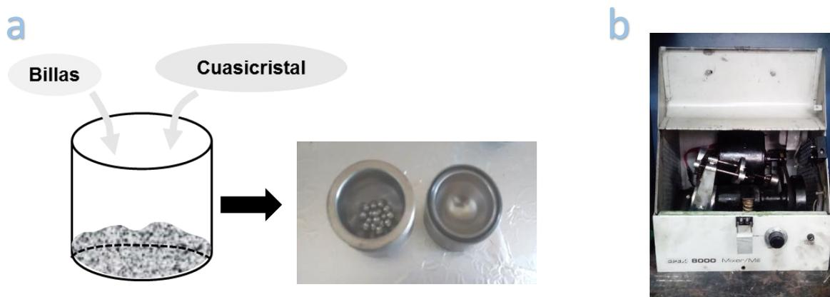
**Figura 3.5.** a) Esquema de la preparación del contenedor con la muestra cuasicristalina y las billas para la nanoestructuración y b) molino vibratorio SPEX SPX8000M.
