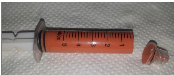
Figura 4. Corte del extremo de la jeringa estéril de 5 cc.
