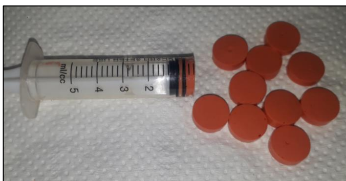
Figura 5. Especímenes de alginato de 5 mm de diámetro y 2 mm de grosor.
