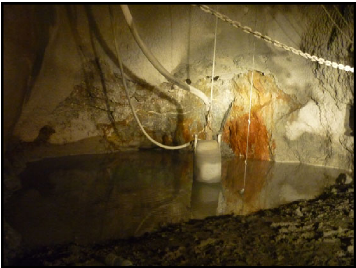
Fig 6.4: Bomba sumergible en una labor en interior mina
