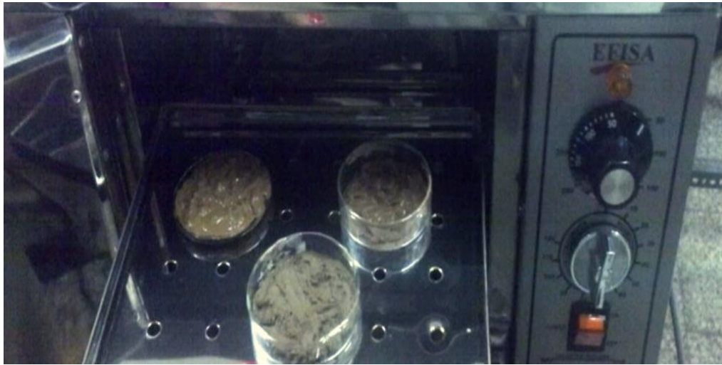
Figura 26. Muestras húmedas en la estufa para ser secadas a una temperatura de 40°C (Fotografía: Autoría Propia)
