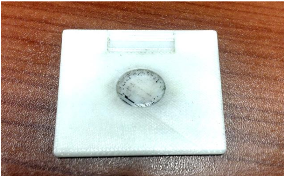
Figura 28 . Porta muestra de 15 mm de diámetro y 1.5 mm de espesor. (Fotografías: Autoría propia)
