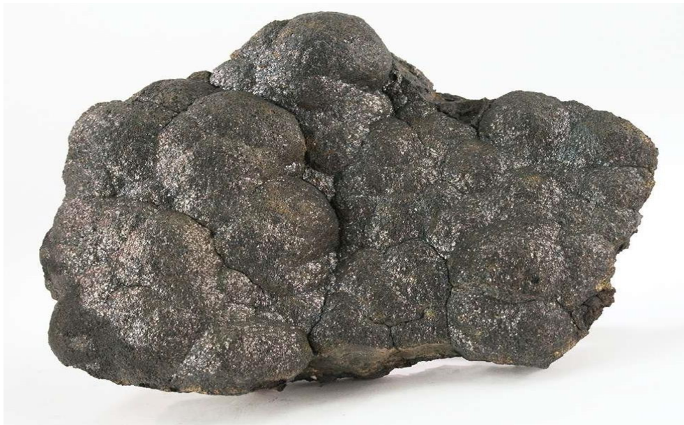
Figura 13 Elemento nativo arsénico (As). Su coloración gris oscuro corresponde al arsénico oxidado ya que su color original es de blanco-estaño (muy poco frecuente). Generalmente asociado a antimonio, plata, cobalto, o minerales con níquel. (Fuente: http://www.irocks.com/minerals/specimen/42278 )
