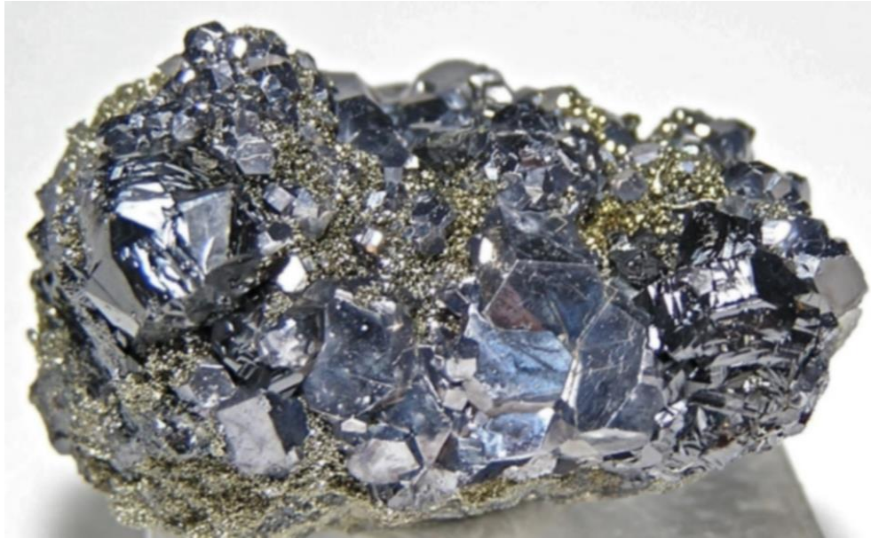
Figura 11 Mineral galena que viene a ser un tipo de sulfuro compuesto con plomo (PbS), destacan formaciones de cristales cúbicos debido a su sistema cristalino.
