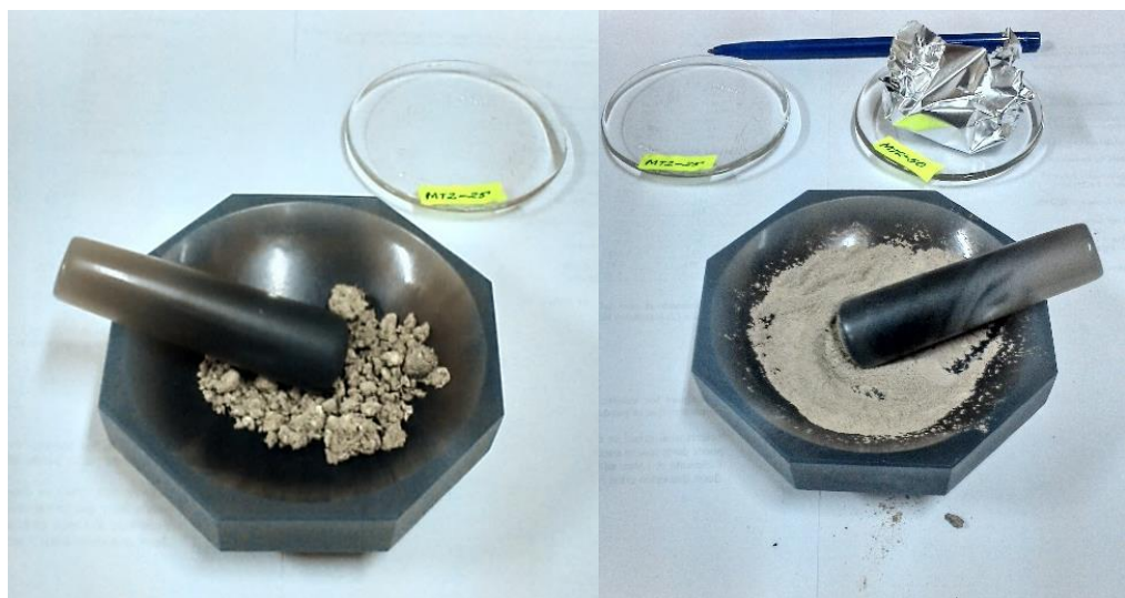
Figura 27. Un mortero de ágata donde se realizó la pulverización de las muestras.
