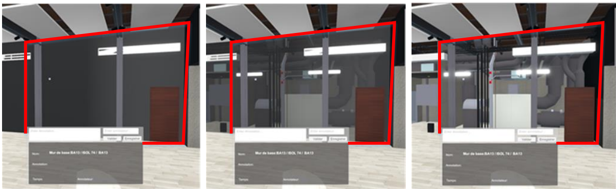
Figure 6 Effet du changement du niveau de transparence (de gauche à droite : transparence = 0% ; transparence = 50% ; transparence = 100%)
