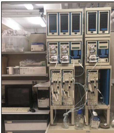
*Figura 13. Equipo de purificación Power-Prep.*
