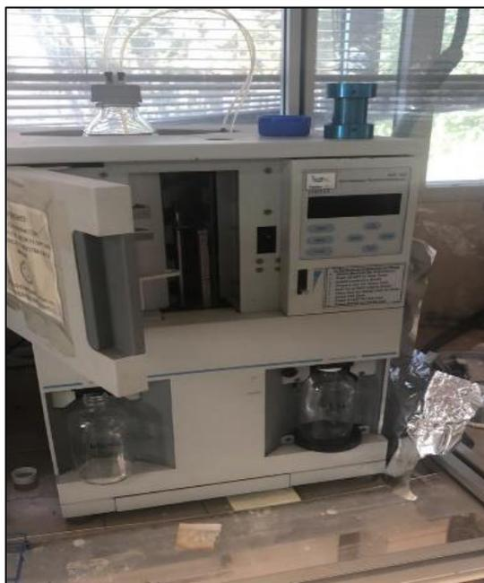
Figura 7. Extractor acelerado ASE 100.
