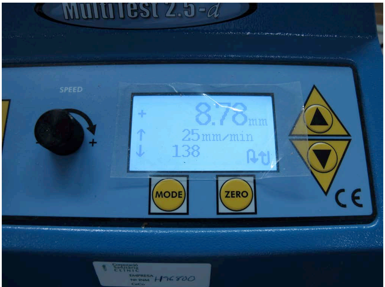
Figura 30. La velocidad de tensionado fue de 25 mm/minuto, y la velocidad de destensionado fue de 140 mm/minuto, requiriéndose aproximadamente un total de 5 horas para el exámen de cada muestra.
