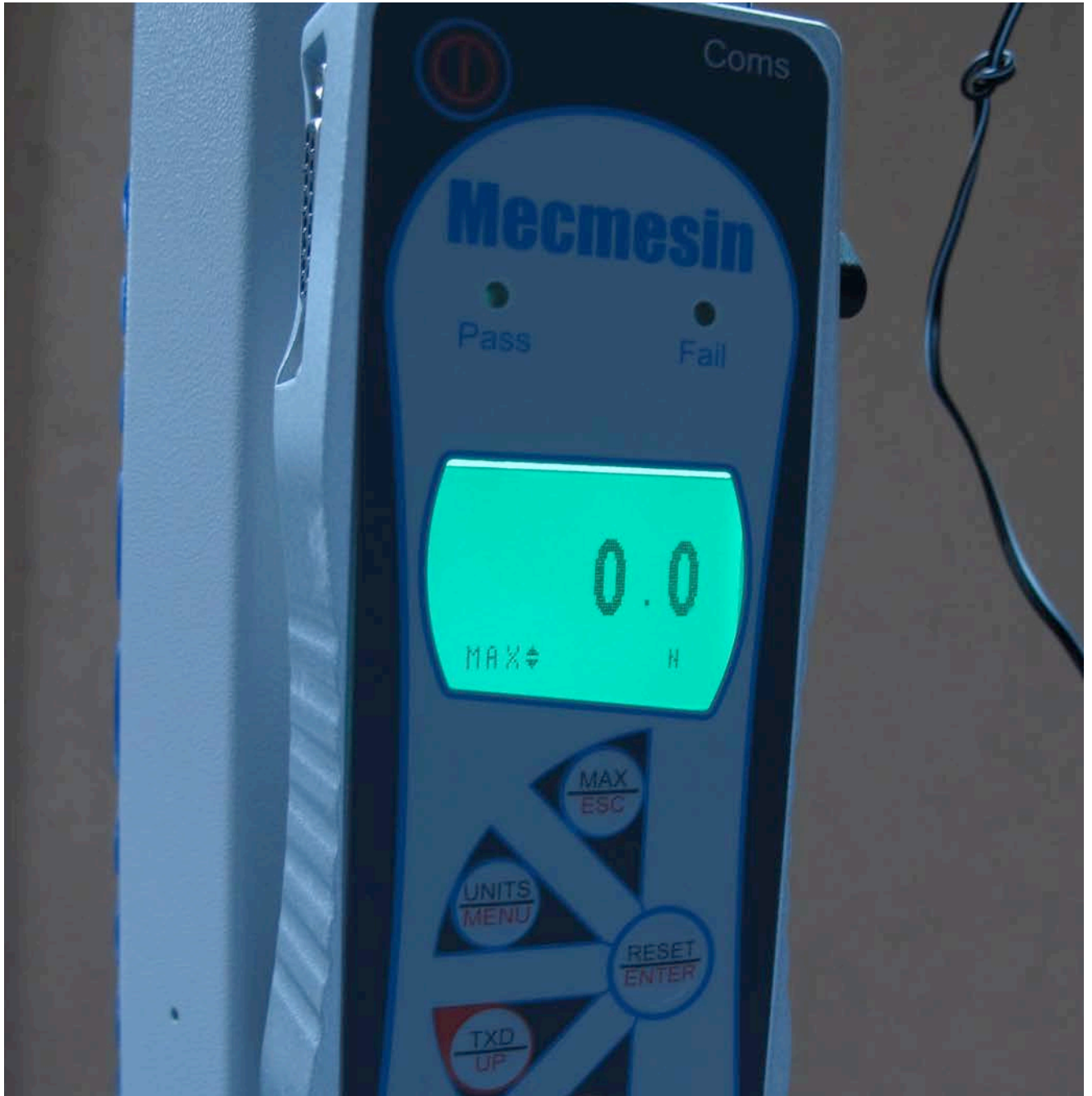
Figura 26. C) Tras haberse realizado el pretensado o preacondicionado a 2 Newtons tres veces antes de comenzar el estudio dinámico, se fija como cero esa situación en el dinamómetro.
