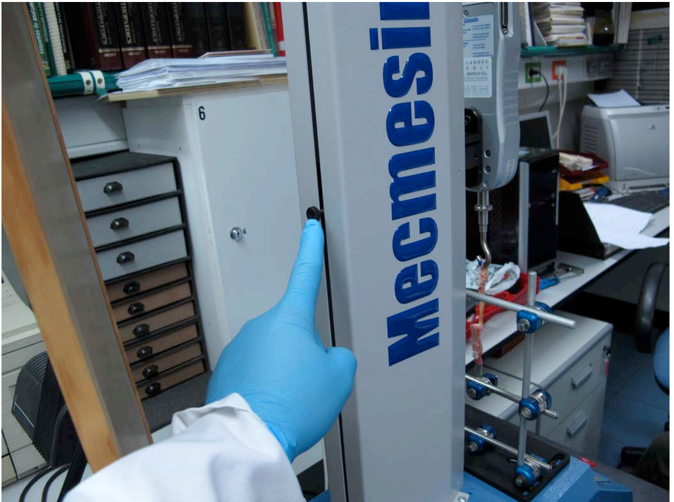
Figura 27. Ajuste del límite óptico inferior del brazo de la plataforma, de forma que al descender el dinamómetro no baje por debajo del punto definido como cero del experimento.
