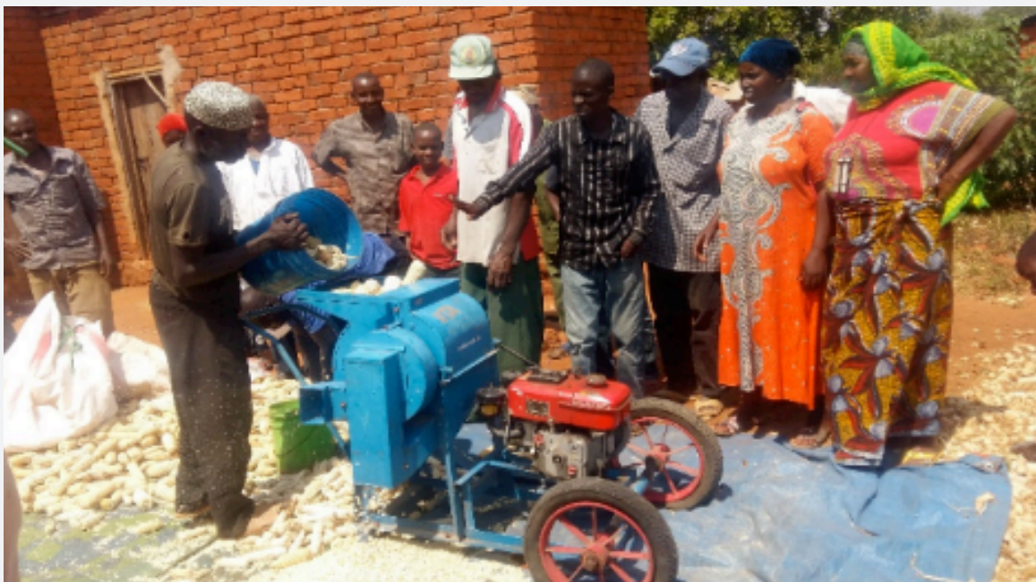
Kielelezo Na.9. Wakulima wakijifunza namna ya kutumia mashine ya kupukuchua mahindi inayotumia injini ya dizeli katika kijiji cha Kitunduweta, Wilaya ya Kilosa. Picha: Cristopher Mutungi/IITA.
