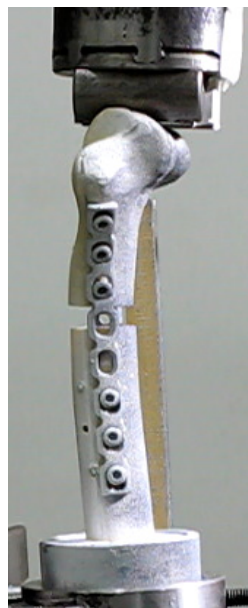
Sl. 2. Opterećenje ispitnih modela: savijanje a), aksijalno opterećenje b), postranično opterećenje c)
