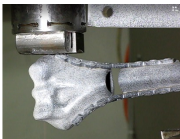
Sl. 2. Opterećenje ispitnih modela: savijanje a), aksijalno opterećenje b), postranično opterećenje c)
