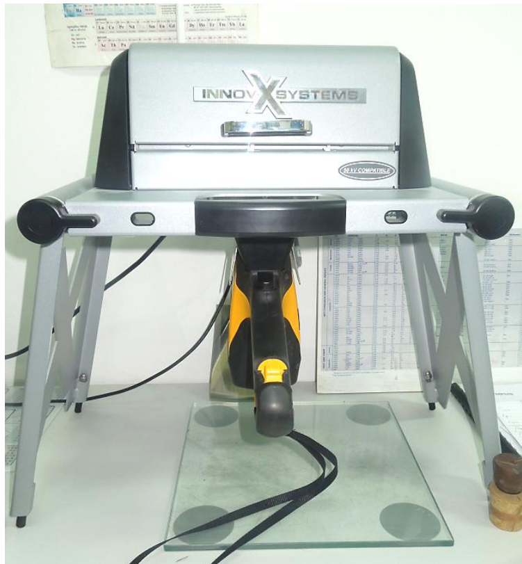
Slika 21. XRF uređaj za provjeravanje kemijskog sastava materijala
