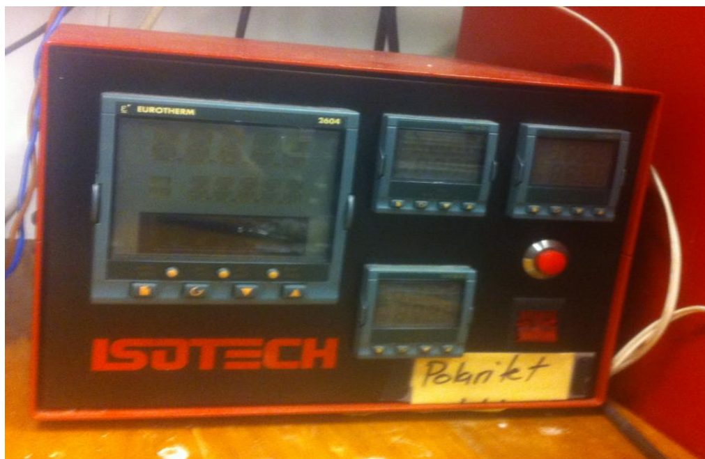
Slika 6. Temperaturni regulator peći
