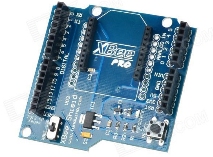
Slika 27. XBee štit ( engl.shield )
