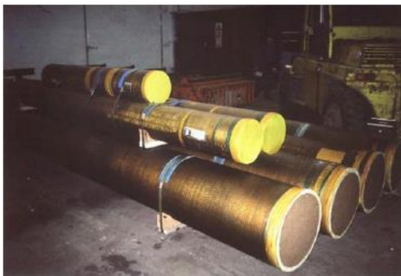
Slika 12. Privremena zaštita unutrašnjosti cijevi praškastim inhibitorima korozije [12]
