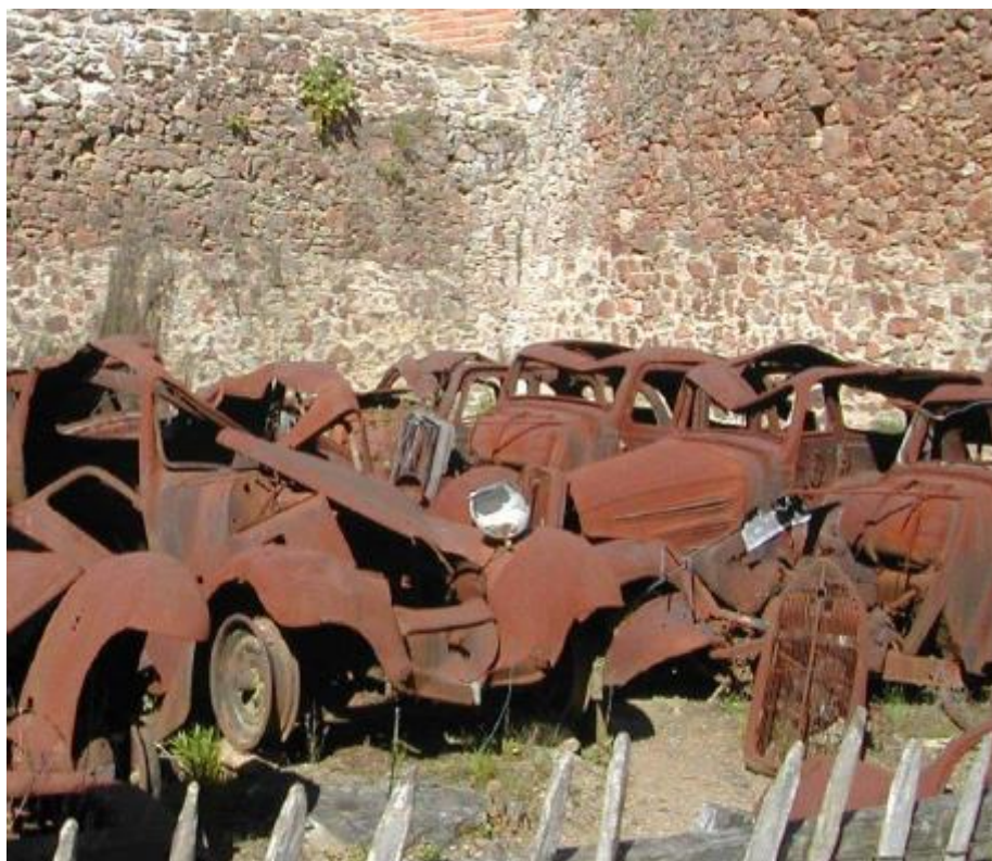
Slika 2. Primjer opće korozije [3]
