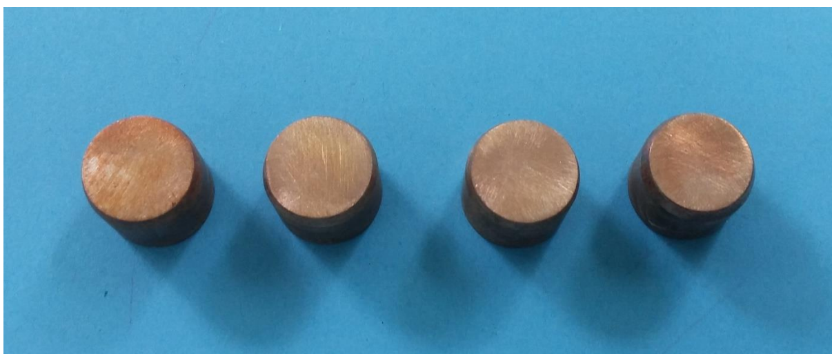
Slika 40. Rezultati VIA testa uzoraka od bakra ispitivanih PE folijom debljine 100 \mu\text{m}
