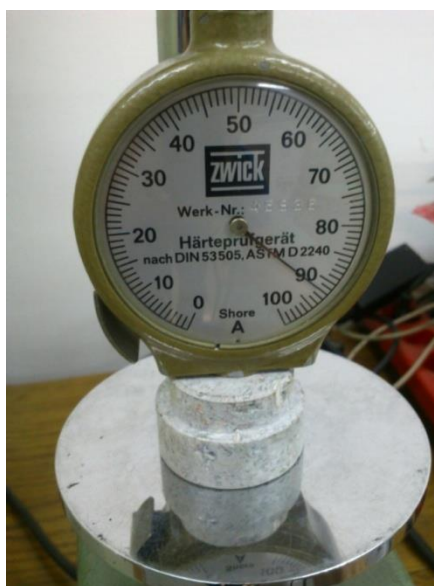
Slika 36. Ispitivanje tvrdoće na Shore A tvrdomjeru Zwick
