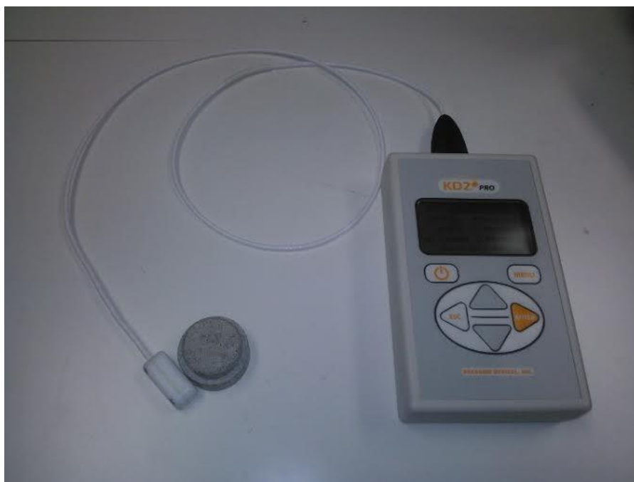
Slika 26. Prijenosni analizator toplinskih svojstva KD2 Pro
