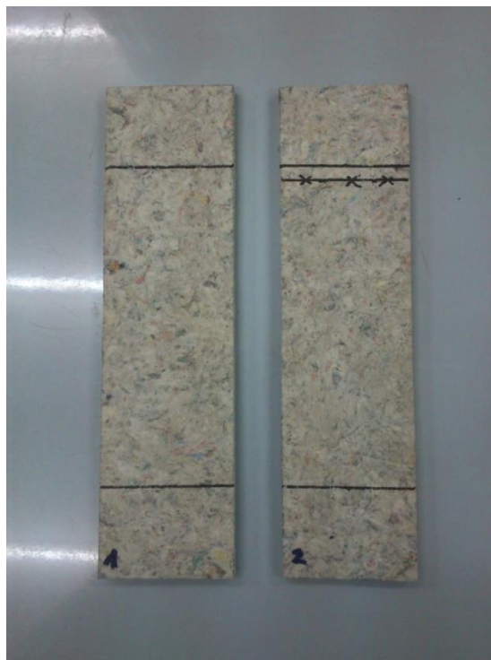
Slika 41. Epruvete prije ispitivanja gorivosti i samogasivosti
