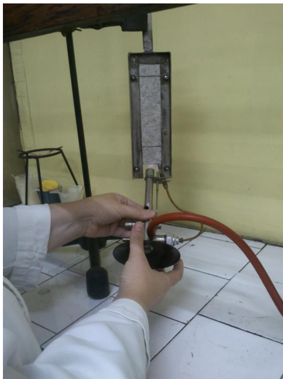
Slika 42. Epruveta tijekom ispitivanja gorivosti i samogasivosti
