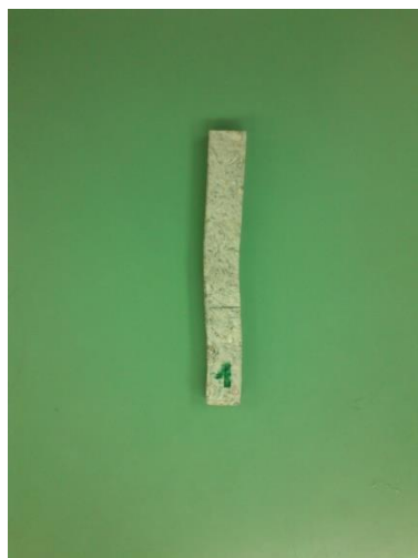
Slika 31. Ispitivanje statičke tlačne čvrstoće na tankoj epruveti
