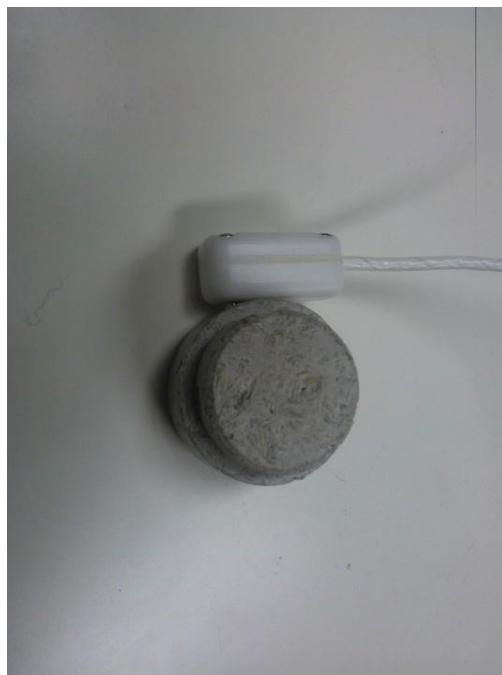
Slika 39. Umetanje senzora za mjerenje toplinskih svojstva u uzorak
