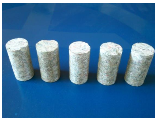
Slika 32. Normalne epruvete za ispitivanje tlačne čvrstoće prema normi ASTM D695
