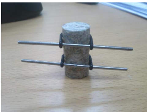
Slika 33. Umetnuti indikatori za mjerenje pomaka tijekom ispitivanja
