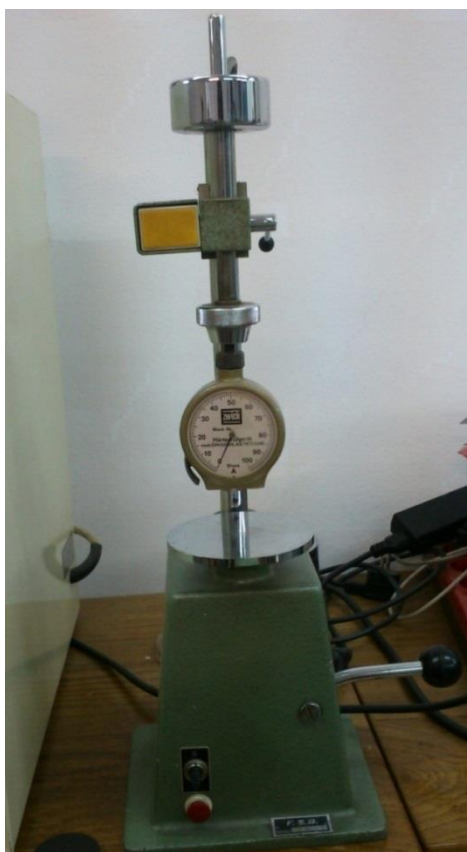
Slika 25. Shore A-tvrdomjer Zwick
