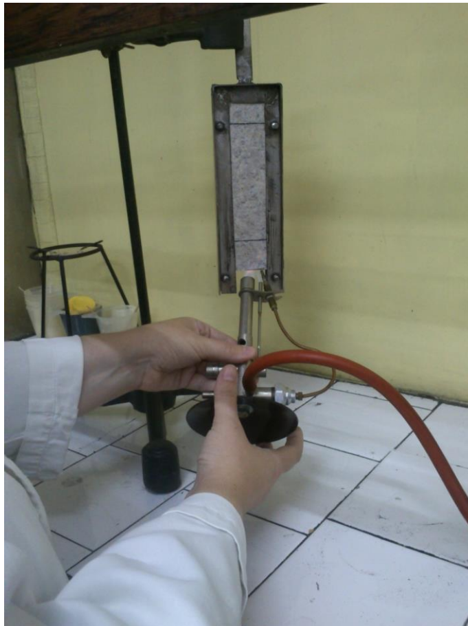
Slika 27. Oprema za ispitivanje gorivosti i samogasivosti
