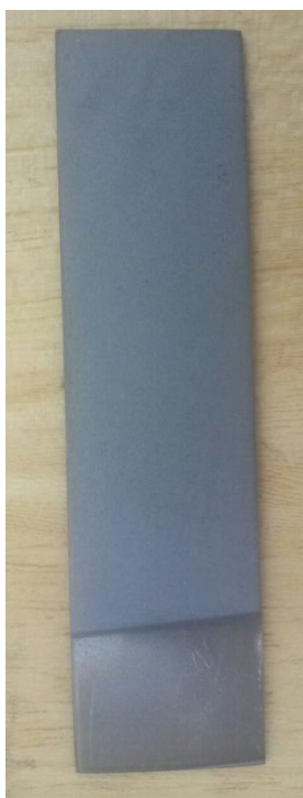
Slika 23. Dobiveni uzorak Cr 3 C 2 prevlake HVOF postupkom naštrcavanja
