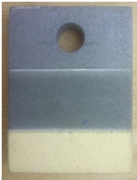
Slika 22. Dobiveni uzorak TBC prevlake APS postupkom naštrcavanja
