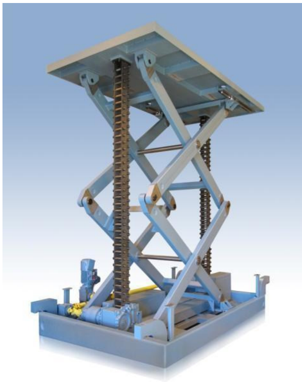
Slika 27. Podizna platforma pogonjena mehanizmom s lancem
