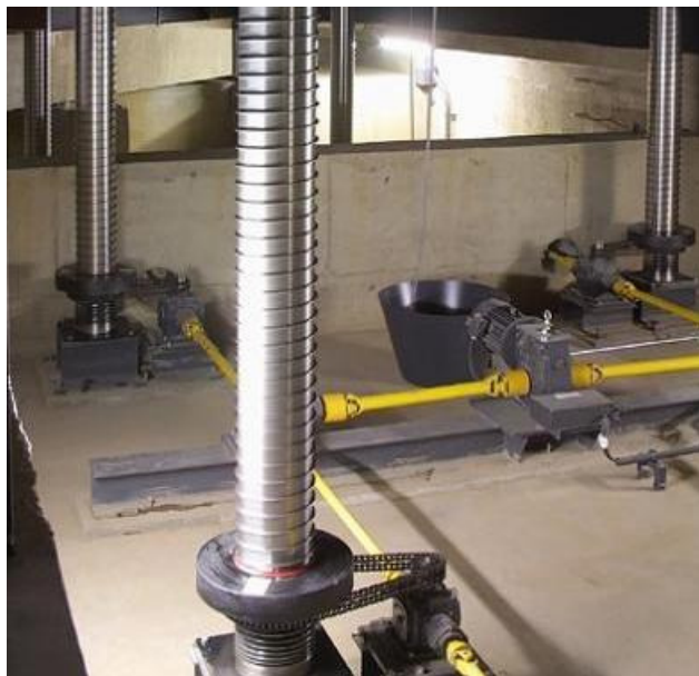
Slika 11. Elektromotorni pogon i prijenosnici snage
