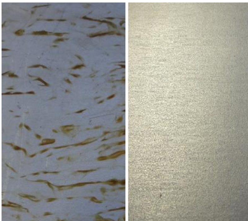
Slika 32. Priprema osnovnog materijala, lijevo-neočišćeno, desno-očišćeno
