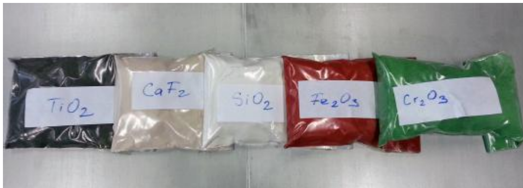
Slika 31. Aktivacijske komponente premaza [31]
