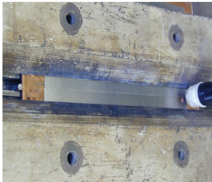
Slika 22. Priprema pri zavarivanju CrNi čelika AISI 304 debljine 1 mm [8]
