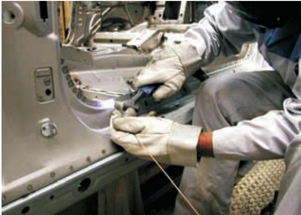
Slika 25. Ručno plazma zavarivanje u BMW-oj tvornici [17]
