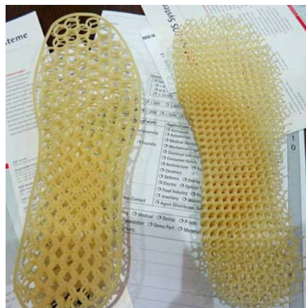
SLIKA 5 – 3D mrežasta struktura načinjena od savitljivog elastomera PrimePart ST (Foto: A. Pilipović)
