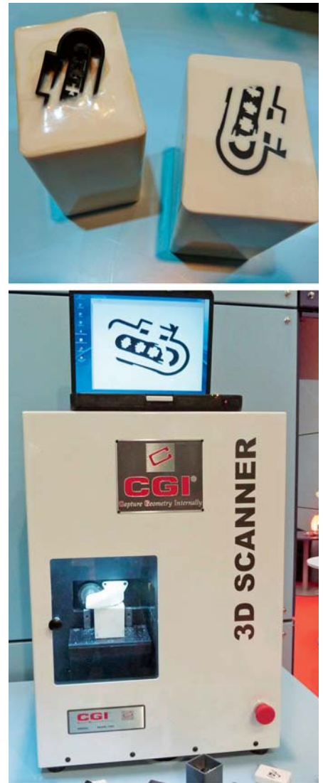
SLIKA 15 – CGI – 3D skener koji reže skenirani model da bi se dobila vanjska i unutrašnja struktura proizvoda (Foto: A. Pilipović)
