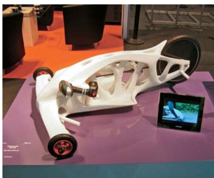
SLIKA 8 – Vozilo pogonjeno električnim pogonom s pomoću Boscheve akumulatorske bušilice (Foto: B. Valentan)
