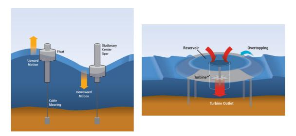
Fig. 5. Oscilating body and overtoping device, [4]Slika 5. Oscilirajući plovak i uređaj s naplavljivanjem, [4]
