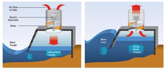
**Fig. 4.** Oscilating water column, [4] **Slika 4.** Oscilirajući stupac vode, [4]
