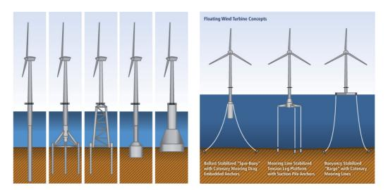
Fig. 1. Different types of fixed and floating offshore wind turbine supporting structure, [3] Slika 1. Primjeri nepomičnih i plutajućih podkonstrukcija pučinskih vjetroturbina, [3]
