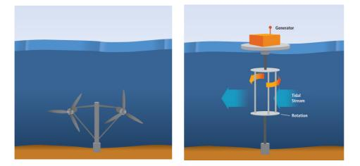
**Fig. 2.** An example of the horizontal and vertical axis tidal turbines, [4] **Slika 2.** Primjer podvodnih pučinskih turbina s horizontalnom i vertikalnom osi vrtnje, [4]
