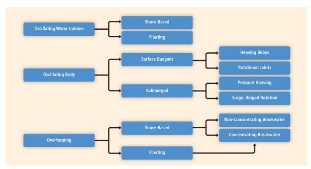
Fig. 3. Classification of wave energy converters, [4]Slika 3. Klasifikacija uređaja za pretvorbu energije valova, [4]
