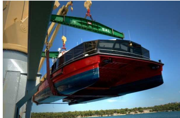
Slika 18. Podizanje katamarana na heavy-lifter
