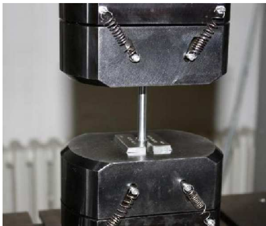
Slika 4a. Epruveta u čeljusti Fig. 4a Specimen in the crosshead
