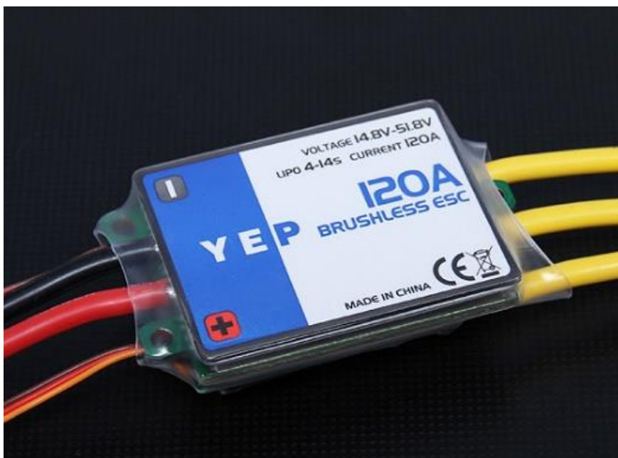
Slika 26. Kontroler za motor (ESC) [8]
