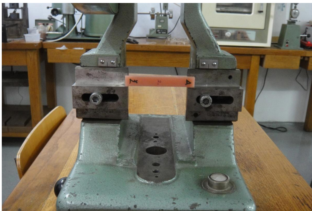
Slika 23: Epruveta u čeljusti Charpy-evog bata
