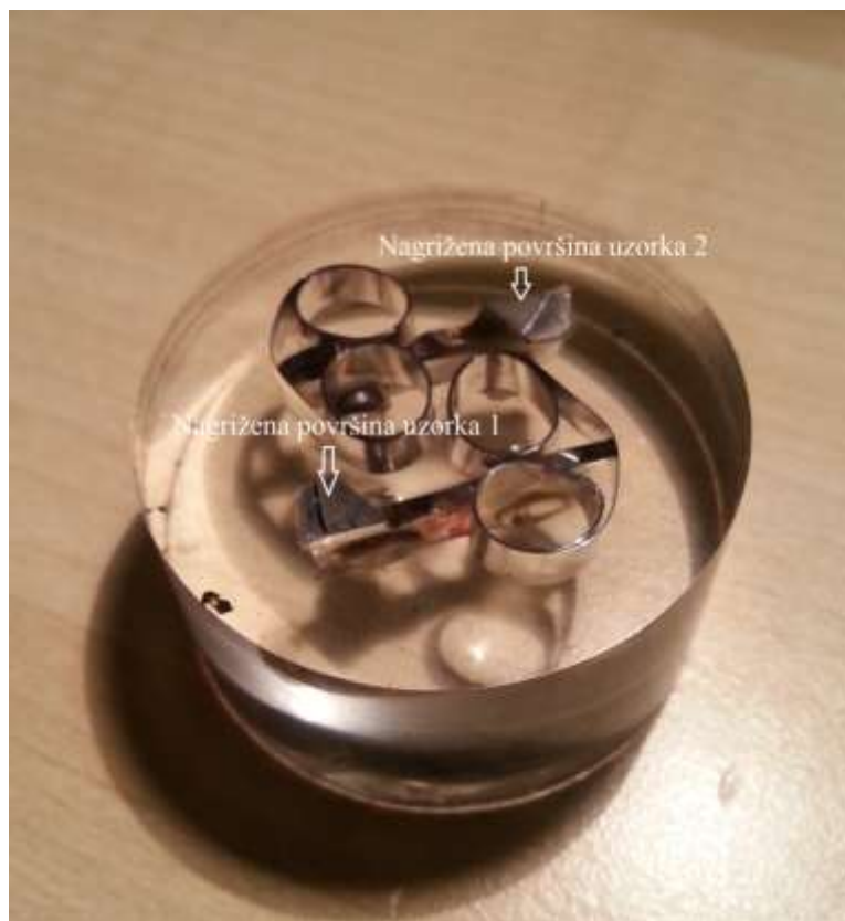
Slika 48. Nagrižene površine uzoraka 1 i 2
