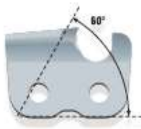
Slika 20. Kut rezanja vršne plohe [9]
