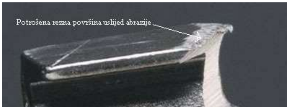
Slika 28. Rezultat abrazivnog trošenja rezne površine reznog zuba
