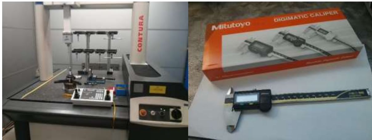
Slika 2.2 Instrumenti za provedbu dimenzionalne kontrole: koordinatni mjerni uređaj (lijevo), pomično mjerilo (desno)
