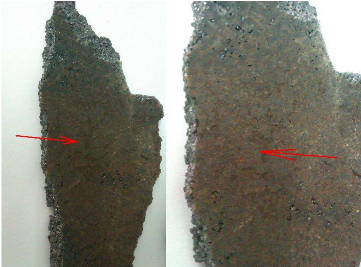
Slika 20. Kontaktna površina prevlake i valjka
