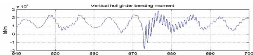
Figure 8 Typical full scale measurements of whipping bending moment of hull girder Slika 8 Tipični prikaz mjerenja u naravi momenta savijanja broskog nosača uslijed podrhtavanja
