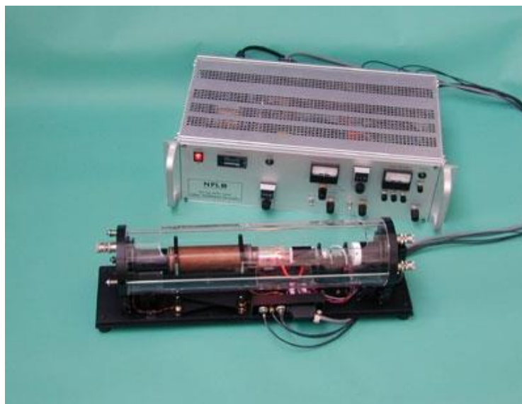
Slika 1 Jodno stabilizirani helij-neon laser
