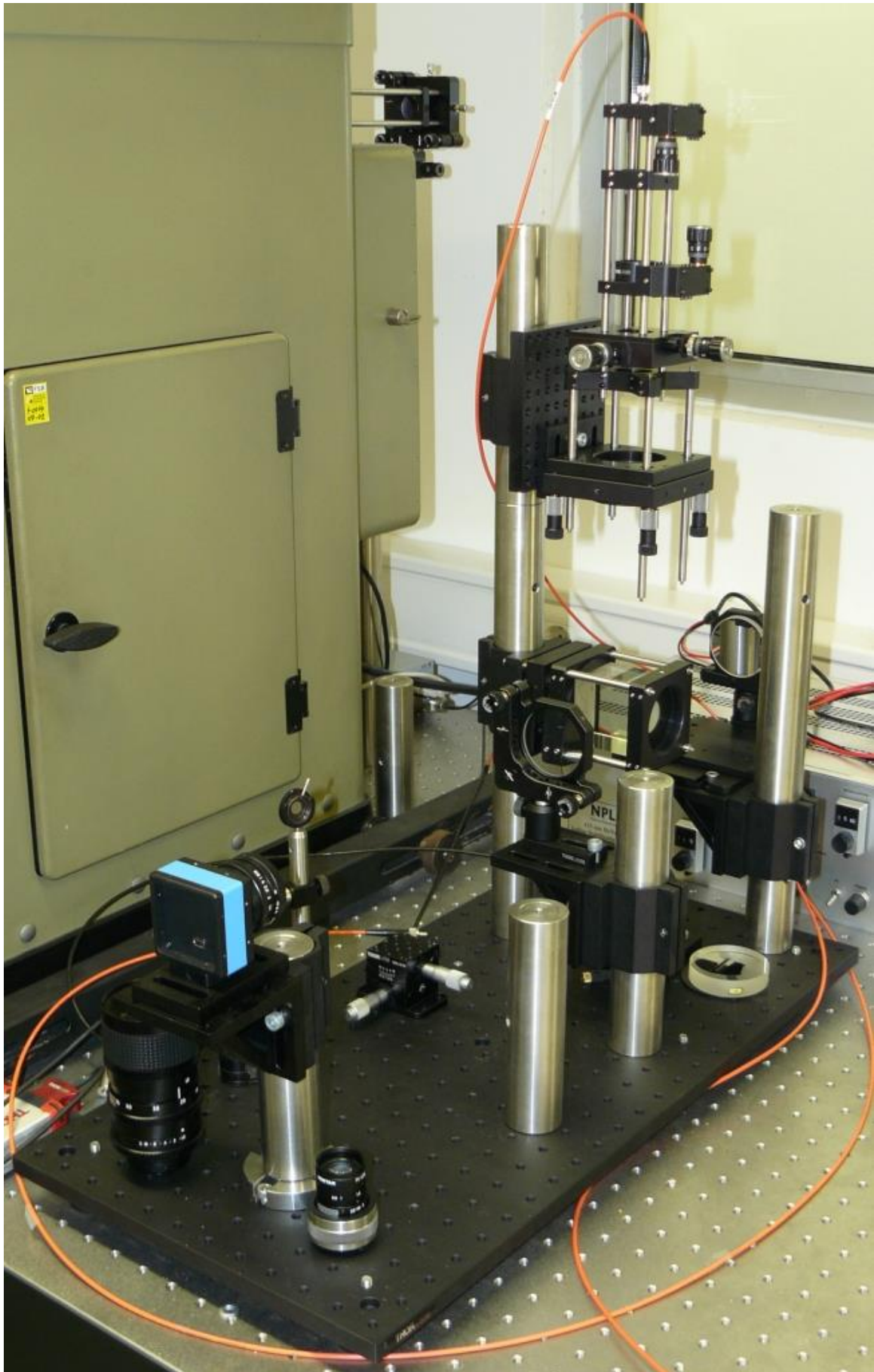
Slika 71 Novi interferometar za granične mjerke.
