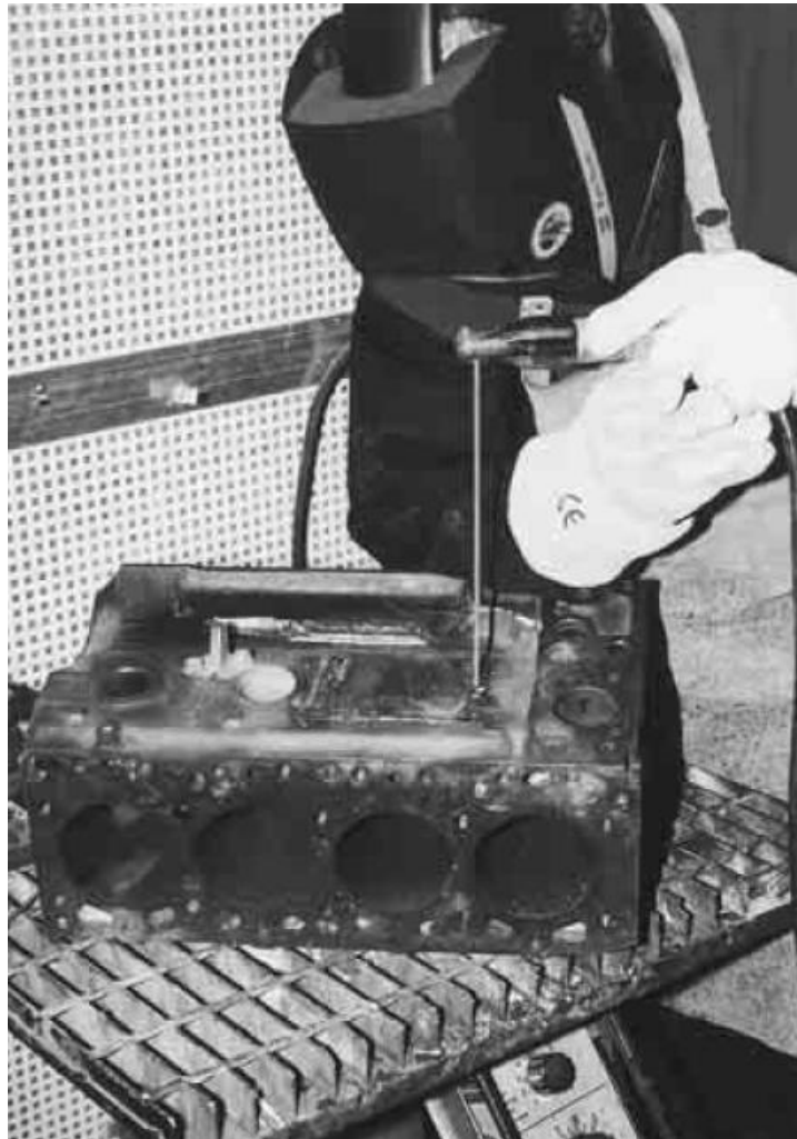
Slika 9. Zavarivanje bloka motora [14]
