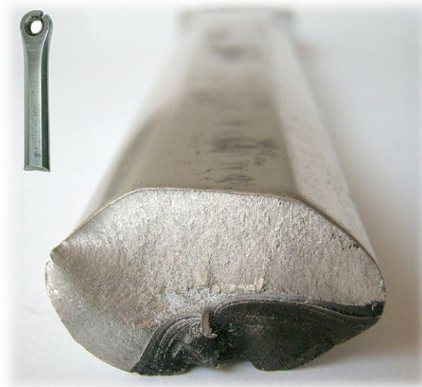
Slika 1. Lom aluminijske ručice uslijed zamora materijala [3]
