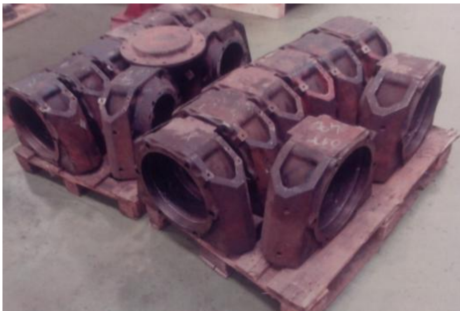
Slika 6. Kućišta osovinskih ležaja s oštećenim dosjedom [12]
