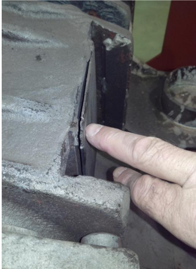
Slika 17. Puknuće zavora na manganskoj pločici ( klizaču )
