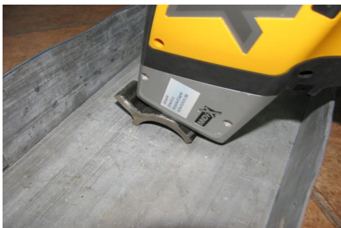
Slika 2. Ispitivanje sadržaja željeza u navaru pomoću XRF, InnovX DELTA uređaja [26]
