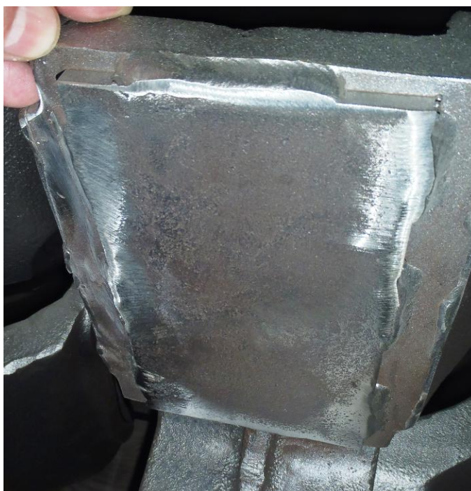
Slika 18. Zavarena središnja ploča za kućište ležaja
