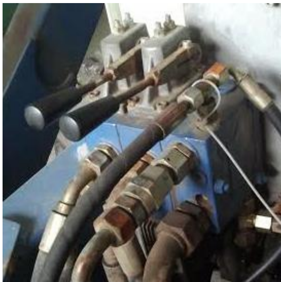
Slika 5. Ručice/poluge za upravljanje „gusjenicama“
