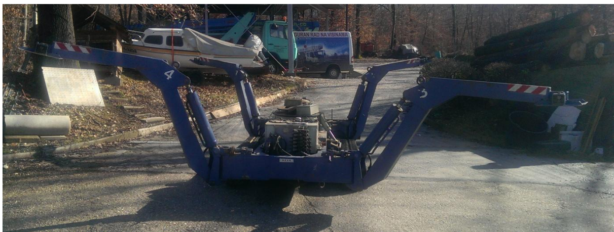
Slika 2. Hidraulička platforma u procesu niveliranja
