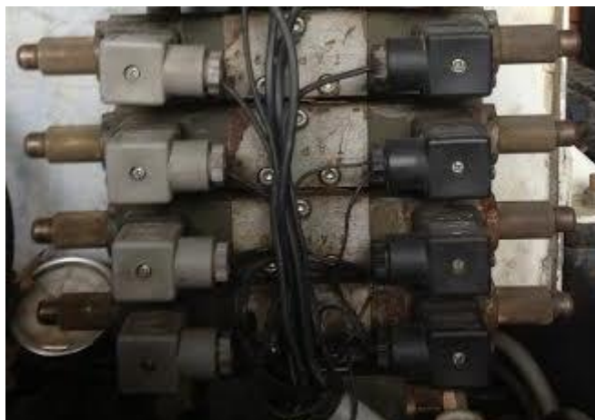
Slika 7. Ticala za izvlačenje/uvlačenje stabilizatora
