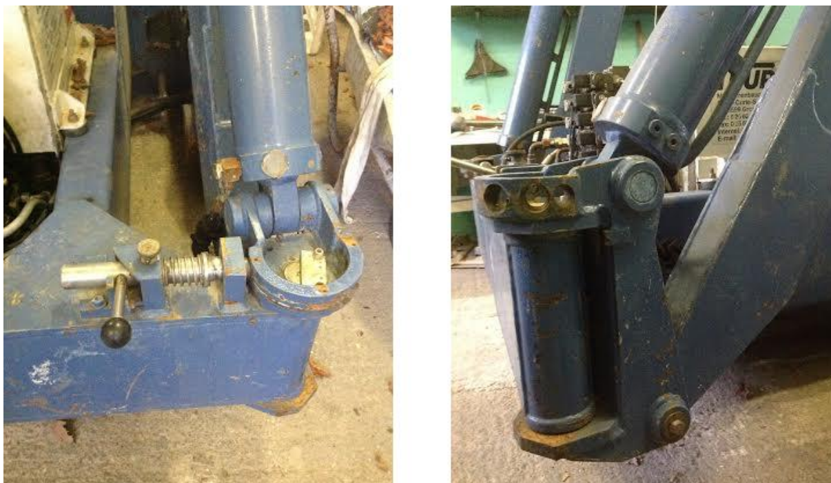
Slika 6. Mehanizam za postavljanje stabilizatora
