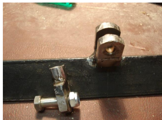
Slika 14. Nosač pneumatskog mišića
