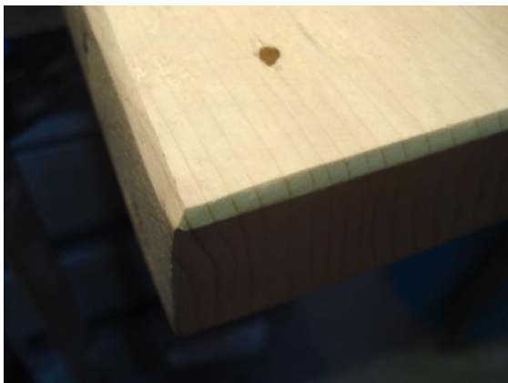
Slika 9. Isturpijan i brušen rub postolja
