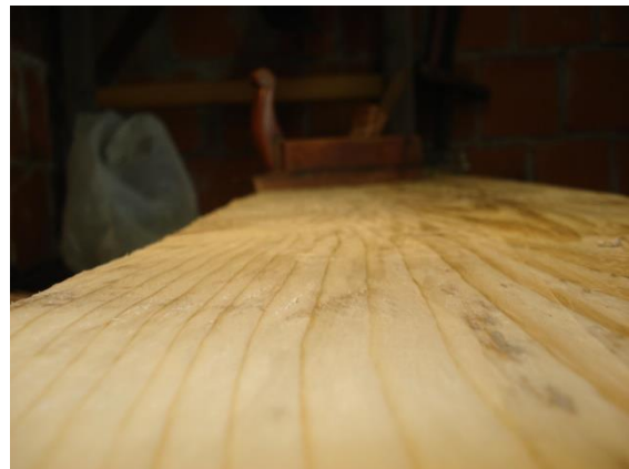
Slika 8. Površina postolja nakon blanjanja
