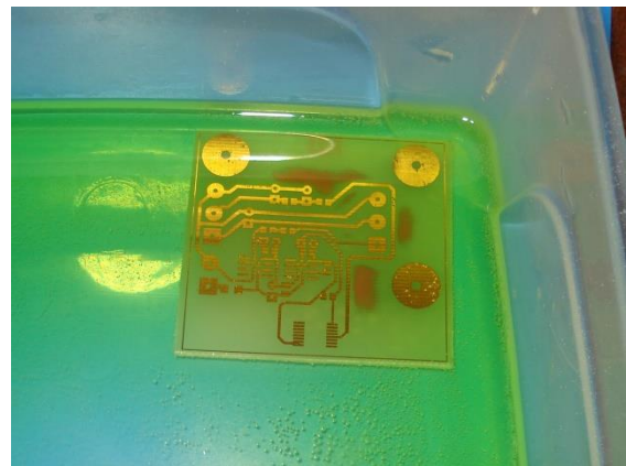
Slika 21. Tiskana pločica – kraj kemijske obrade
