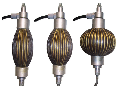
Slika 13: McKibbenov pneumatski mišić
