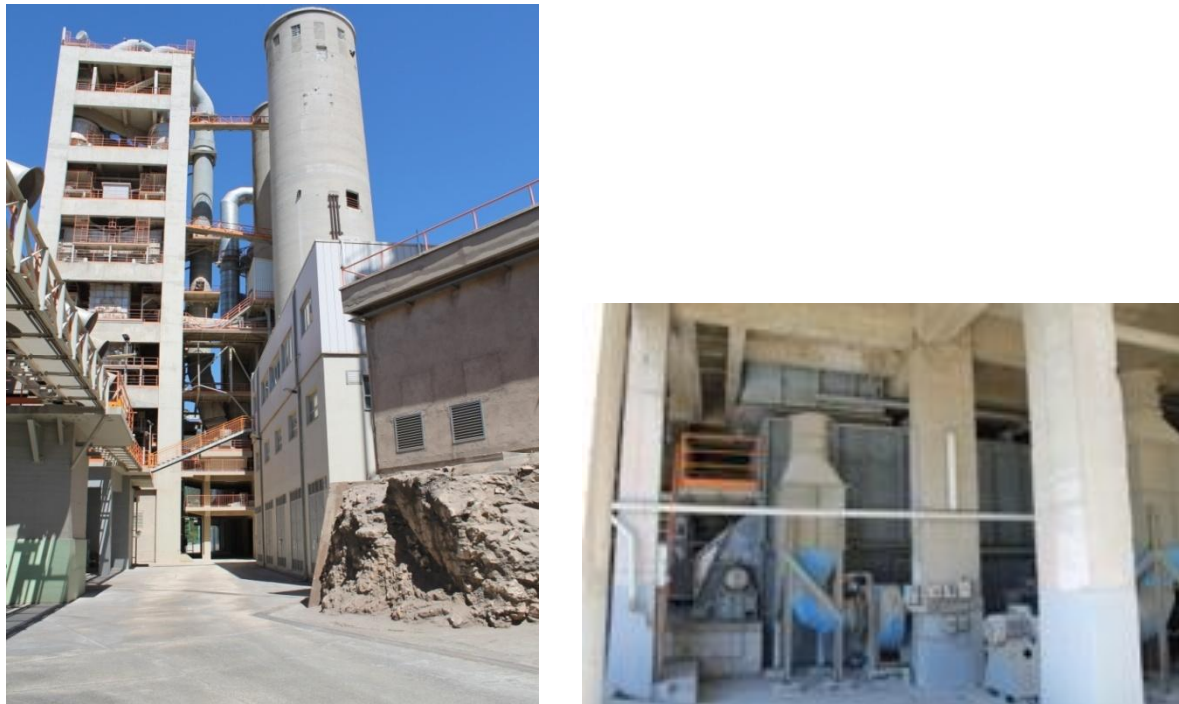
Slika 6. Ciklon i hlađenje klinkera
