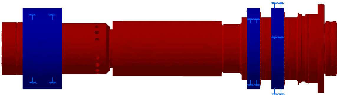
Slika 51. Prva aksijalna forma vibriranja, frekvencije 1093,53 Hz
