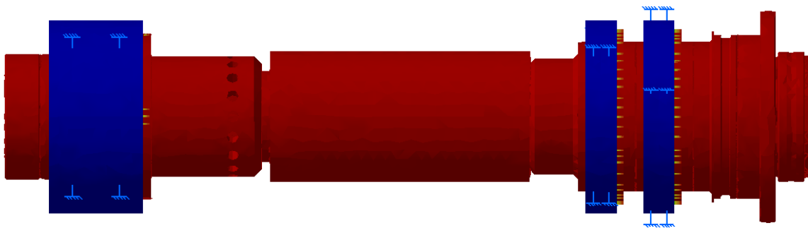
Slika 54. Prva aksijalna forma vibriranja, frekvencije 767,02 Hz
