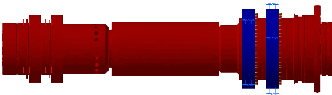
Slika 48. Prva aksijalna forma vibriranja, frekvencije 767,02 Hz
