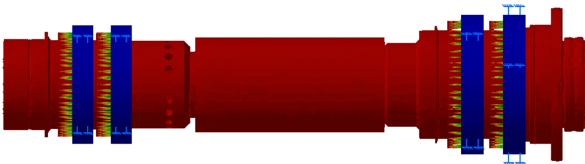
Slika 45. Prva aksijalna forma vibriranja, frekvencije 1093,7 Hz
