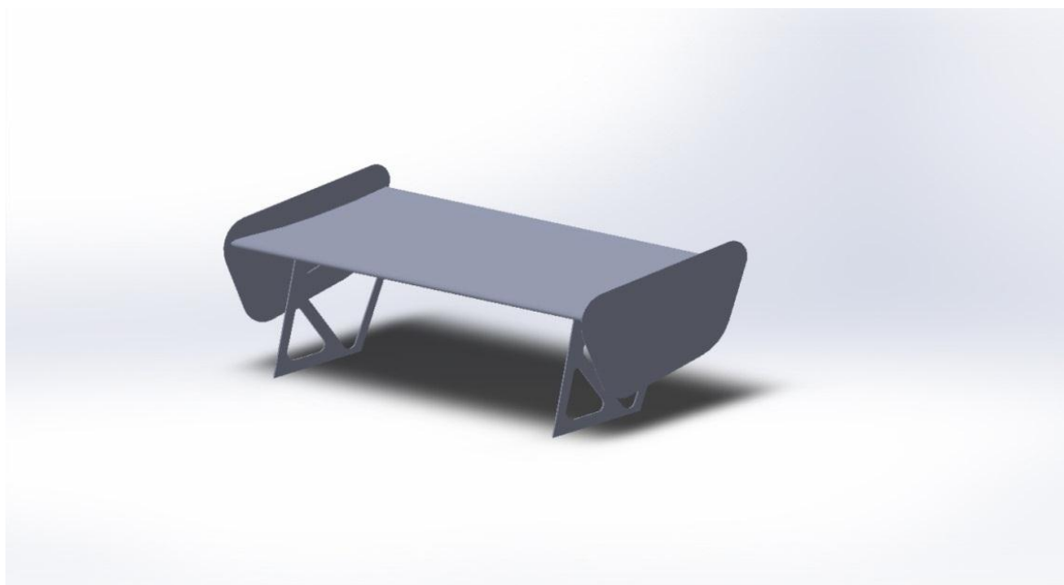
Slika 12. 3D model stražnjeg krila
