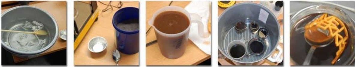
Slika 4.1. Postupak bojanja uranjanjem u kupku (po koracima) [19]
