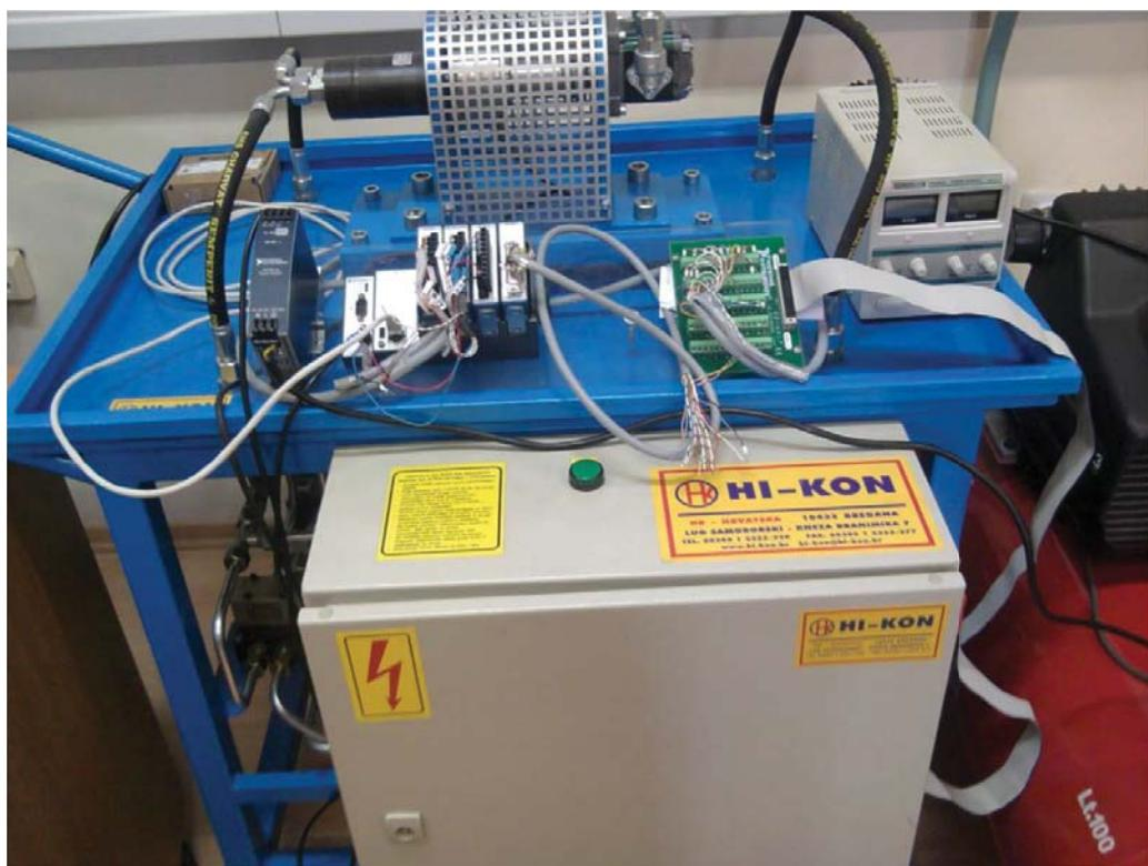
Slika 2.16 Modul rotacijskog elektro-hidrauličkog servo sustava
