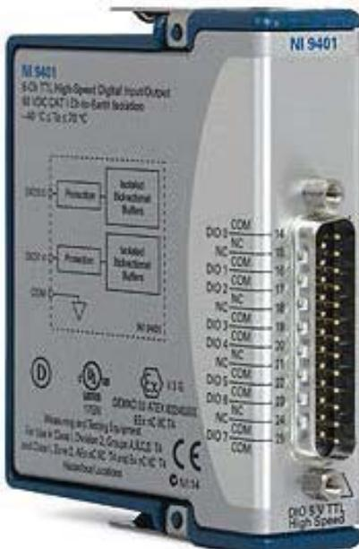
**Slika 2.15 Digitalni ulazni modul NI 9401 (sa brojačima impulsa)**
