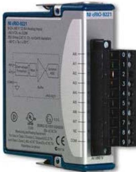
Slika 2.12 Analogni ulazni modul NI 9221
