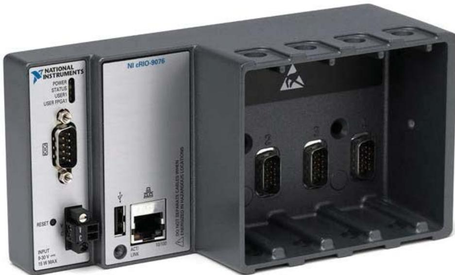
Slika 2.11 Upravljački uređaj NI CompactRIO 9076
