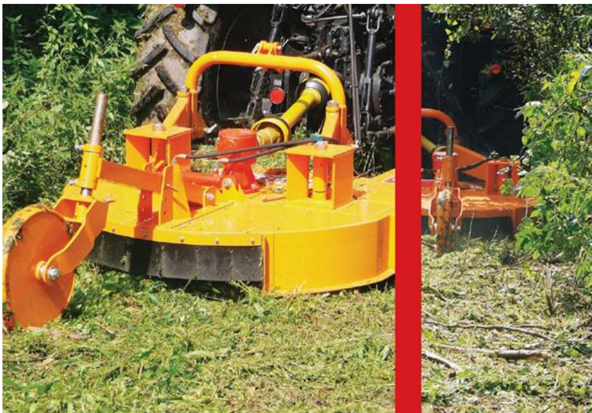
Slika 8. Pomak stroja pomoću hidrauličkog cilindra i polužnog sustava [5]
