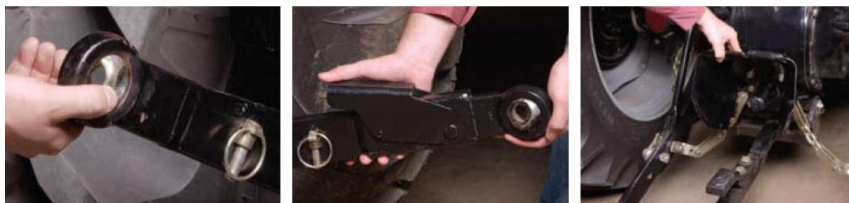
Slika 12. Karakteristični detalji prihвата u tri točke ( engl. Three point hitch ) Križno probušene kugle na krajevima ruku, jedan promjer odgovara priključcima I kategorije dok drugi odgovara priključcima II kategorije (lijevo), teleskopske ruke radi lakše ugradnje priključka (sredina), jednostavna kotrola lateralnog pomaka priključka putem navojnog vretena (desno) [8].
