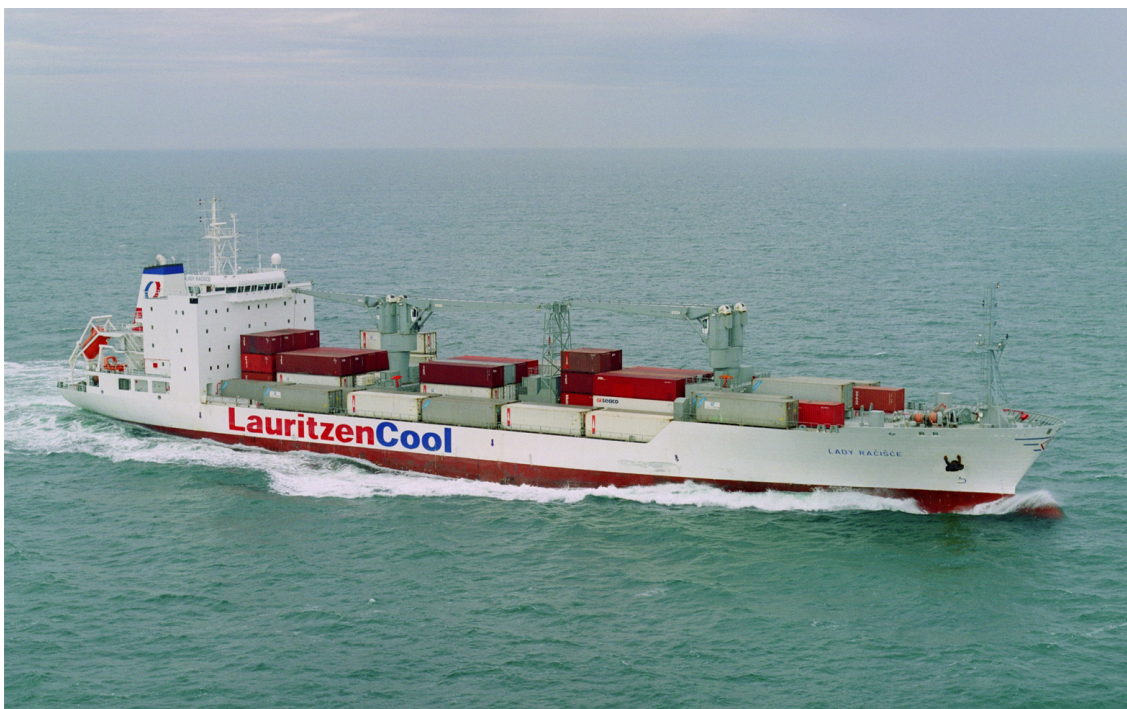
Sl. 2.1. Konvencionalni brod hladnjača "Lady Račišće", izgrađen 2000. godine, ukupnog kapaciteta hladnog prostora od 17.000 m 3 i 260 TEU
