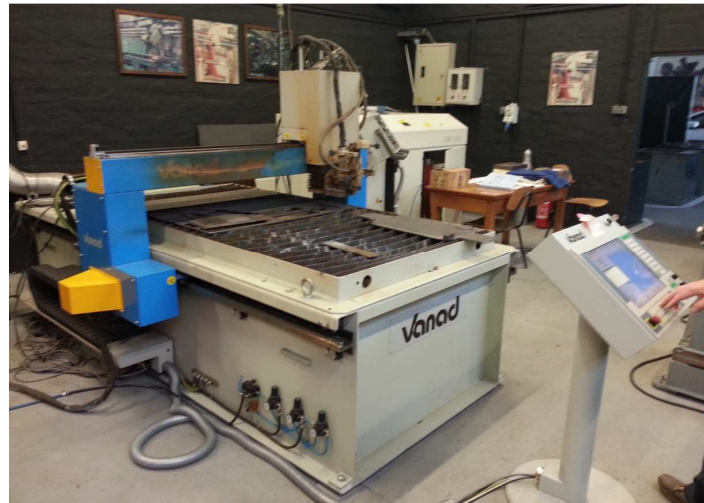
Slika 23. Plazma rezač Vanad za vrijeme izrezivanja jezgri.
