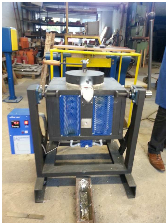
Slika 32. Peć za taljenje aluminija
