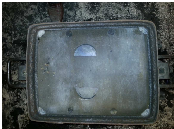
Slika 30. Prikaz pozicioniranog okvira donjaka i hladila
