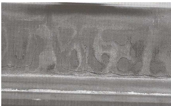
Slika 16. Topla pukotina na odljevku [28]
