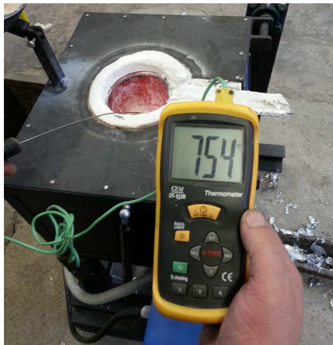
Slika 36. Mjerenje temperature prije lijevanja u kalup
