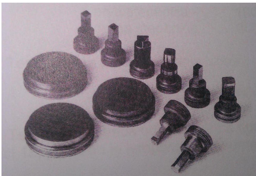
Slika 6. Alati za direktno prešanje [3]
