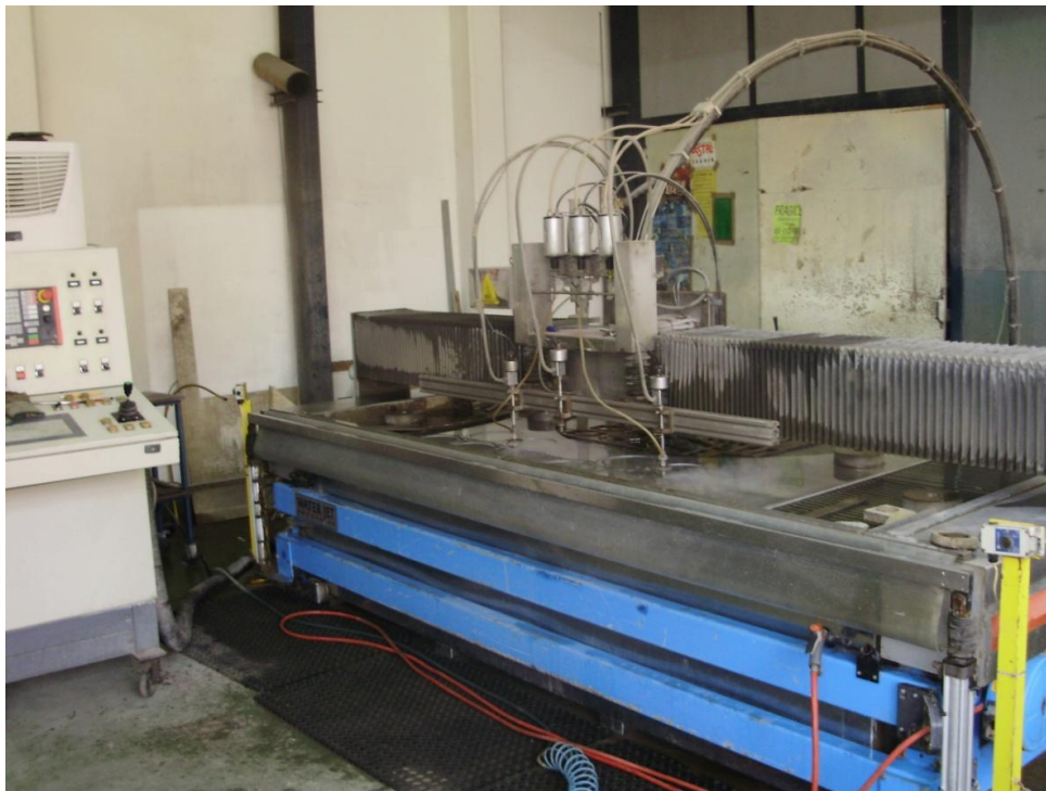
Slika 34. Rezanje vodenim mlazom (WJM)
