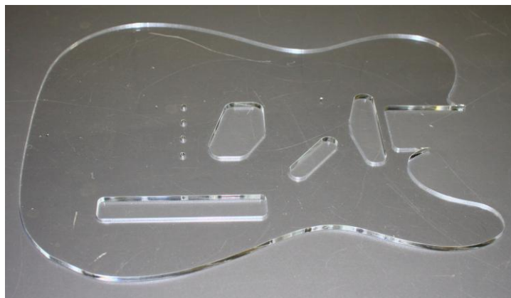
Slika 43. Šablona od pleksiglasa za glodanje utora gitare ručnom obradom
