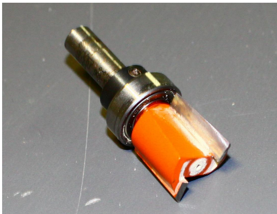
Slika 40. Glodalo korišteno za izradu Al i drvenog tijela
