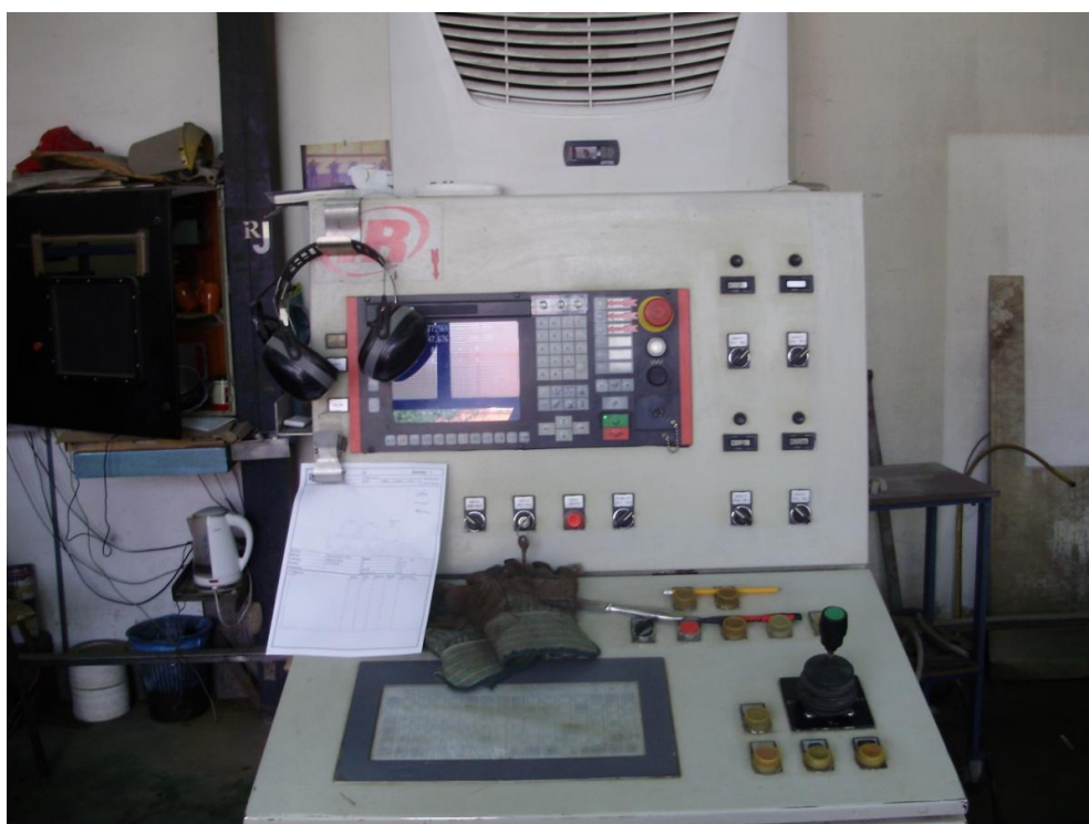
Slika 35. Upravljačka konzola stroja Water Jet Sweden AB NC-3000
