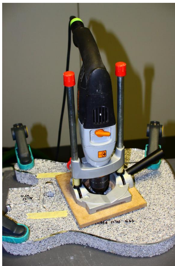
Slika 44. Glodanje utora na tijelu gitare pomoću šablone
