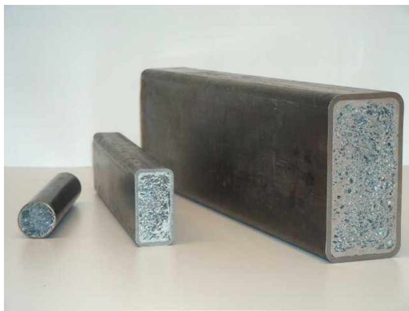
Slika 25. Sendvič konstrukcija s jezgrom od metalne pjene [11]
