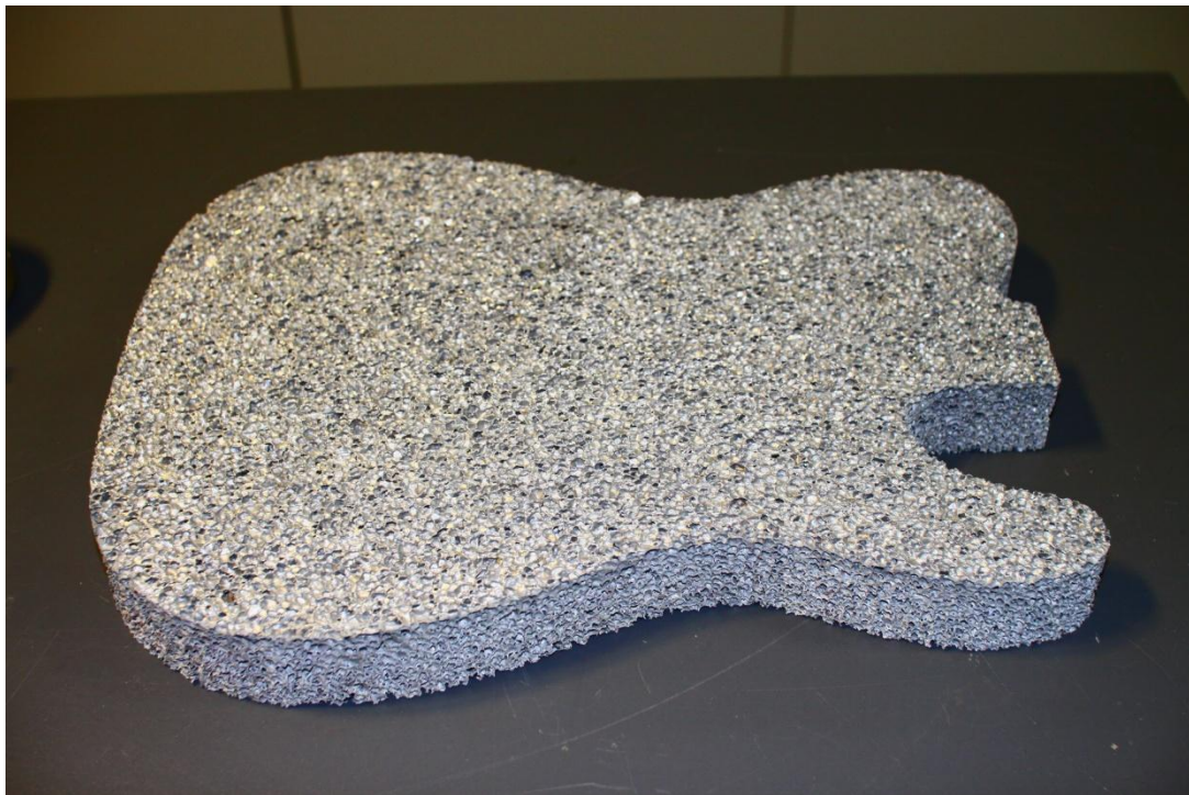
Slika 36. Tijelo električne gitare dobiveno rezanjem vodenim mlazom
