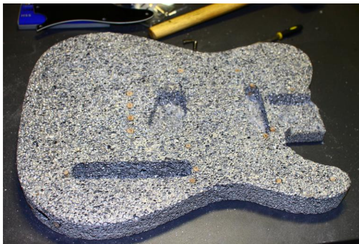
Slika 45. Tijelo gitare od Al pjene dobiveno nakon obrade
