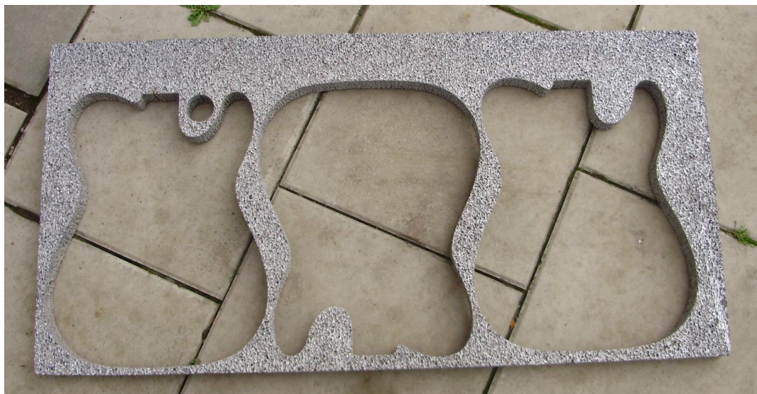
Slika 37. Ploča nakon rezanja vodenim mlazom
